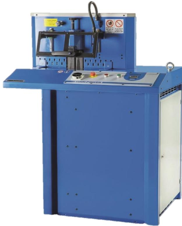
Finn-Power CM91 SAFE ホースカッターはCM91と同じ容量で、電気安全装置とモーターブレーキが追加されています。
