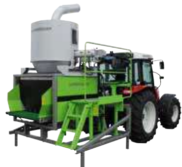
Cibus TRM トラクタ搭載型サイレージコーン、バイオエタノール 原料用ハーベスター
