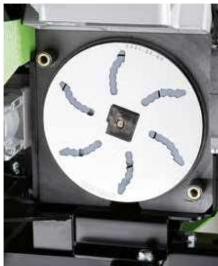
放射スロットディスク、及びその裏のスパイラルスロットディスク
