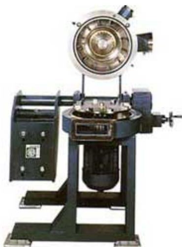
ネアミルは新しい着想のもとに開発された、分級機を内蔵した衝撃式微粉碎機です。モース硬度1～3(タルク・黒鉛～石灰石)の原料に適しています。粉碎室のサイズ変更や豊富なパラメータ設定によって、幅広いニーズに対応します。
